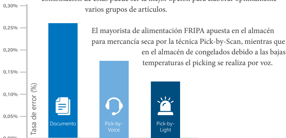
Tasa de error de las distintas tecnologías de picking (W.A. Günthner, T. Rammelmeier: Eliminar los errores de picking con Pick-by-Vision, Múnich 2012)
